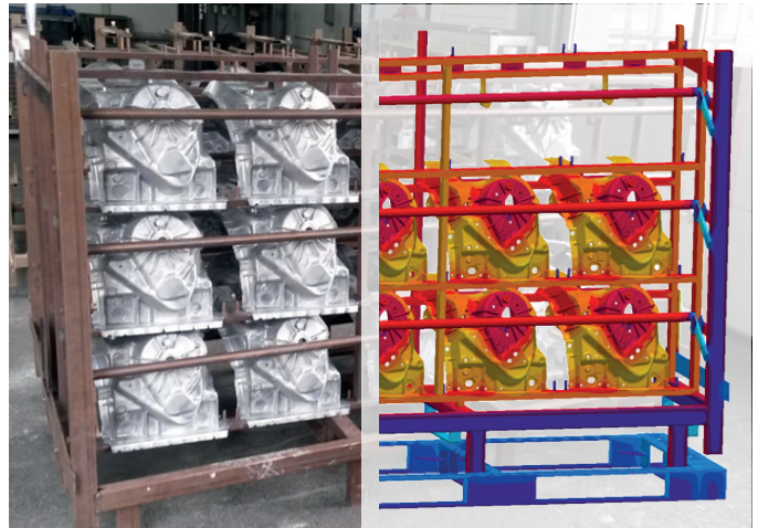
Döküm parçaları gerçek proste olduğu gibi bir ısı işlem rafı üzerinde simüle edilebilir
