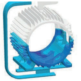
Hava sıkışmasının görüldüğü orijinal (solda) ve optimize edilmiş (sağda) yolluk sistemi
