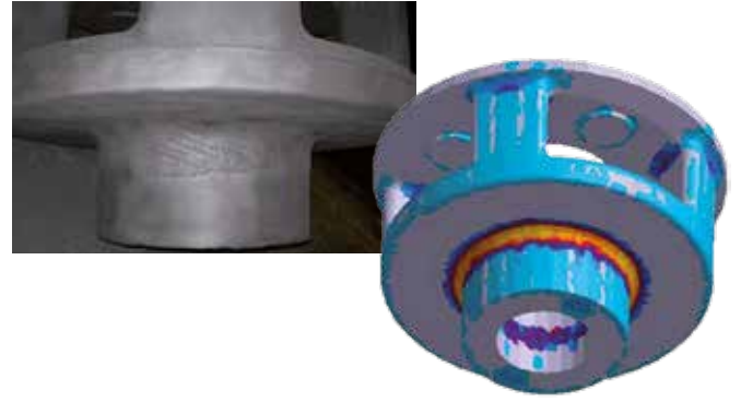
Gerçek parça ile örtüşen sinter oluşum simülasyonu
