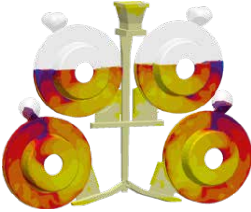
Dört gri dökme demir fren diskini kalıp dolum karakteri
