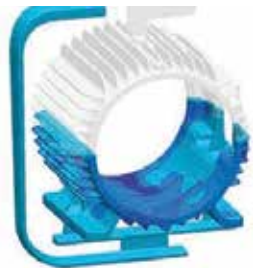
Hava sıkışmasının görüldüğü gerçek (solda) ve optimize edilmiş (sağda) yolluk sistemi
