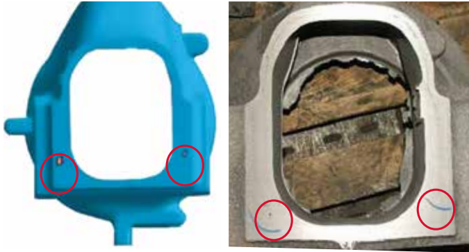
Sfero bir parçada görülen poroziteler
