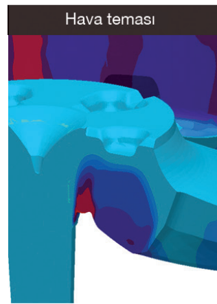
Kalıp dolum ve soğuk birleşme veya oksit kalıntıları gibi potansiyel döküm kusurlarının analizi için MAGMASOFT® sonuçları
