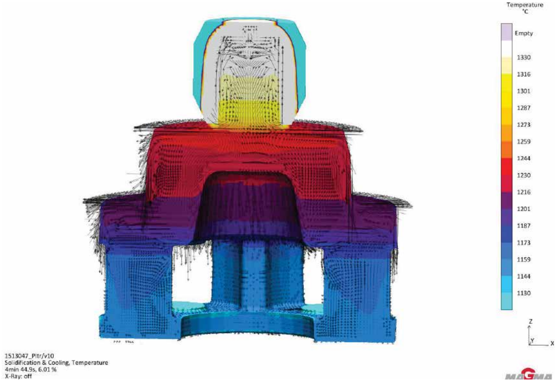
[Şekil. 1] Katılaşma sırasındaki termal konveksiyonun besleme davranışına etkileri
